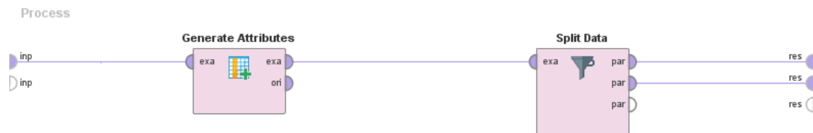
Slika 4.4. Proces podjele podataka primjenom Split Data operatora
