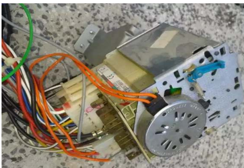
Slika 3.12. Vanjski izgled programatora perlice rublja.
