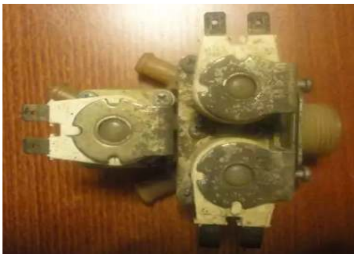
Slika 3.21. Vanjski izgled elektroventila perilice rublja.
