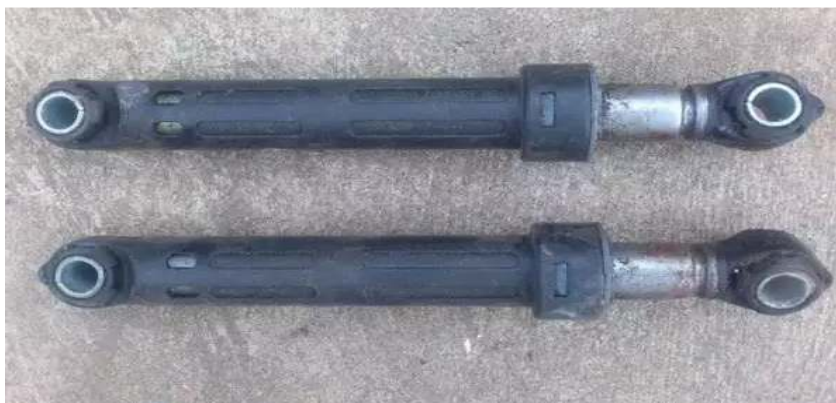
Slika 3.3. Izgled amortizera perilice rublja.
