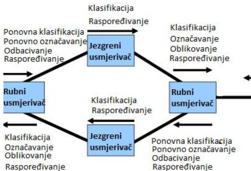
Slika 4.2.2.1. Model QoS-a na temelju diferenciranih usluga (DiffServ) [14]
