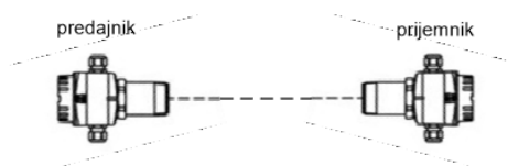
Sl. 3.32. Princip rada mikrovalnog mjerila razine
