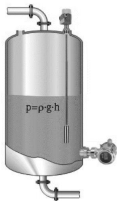
Sl.3.8. Mjerenje razine zatvorenog spremnika
