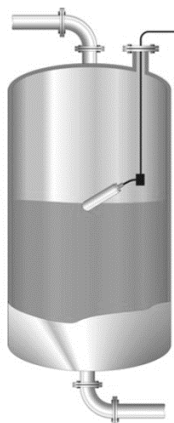
Sl. 3.3. Detektor razine s plovkom
