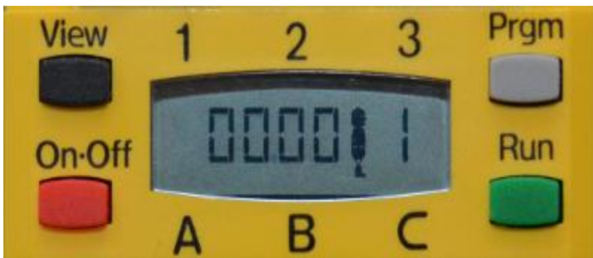
SI.2.8 – Prikaz zaslona upravljačke jedinice nakon prebacivanja firmwarea (Izvor pbrick.info)
