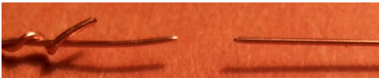
Slika 6.3. Uvećani prikaz puknuća bakrene žice prilikom kidanja
