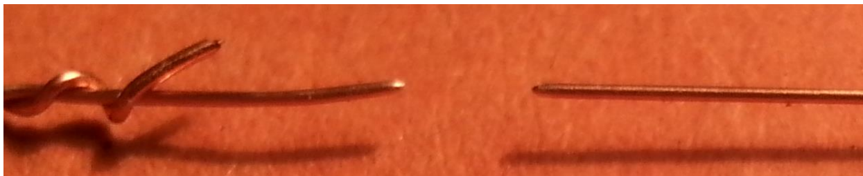
Slika 6.3. Uvećani prikaz puknuća bakrene žice prilikom kidanja
