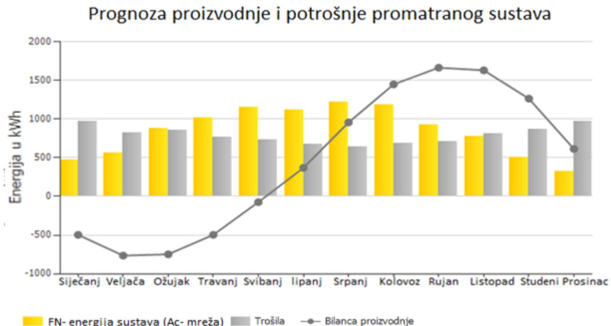
**Slika 5.3.2.** Grafički prikaz prognoze proizvodnje i potrošnje pri utjecaju zasjenjenja dimnjakom
