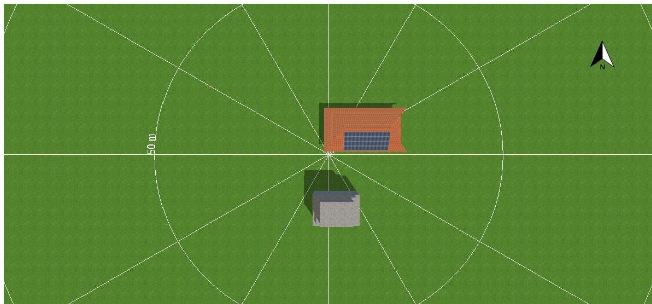
**Slika 5.5.4** Vizualni prikaz položaja susjednog objekta (zgrada) u odnosu na objekt s instaliranim fotonaponskim sustavom iz četvrtog kuta gledanja
