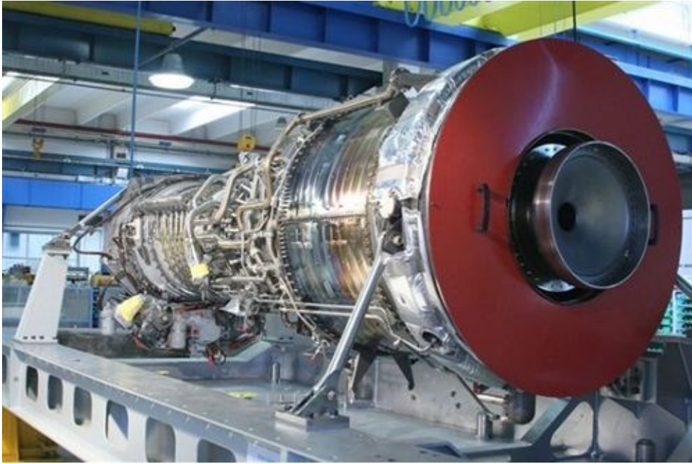
Slika5.3.4. Plinska turbina GE LM2500
