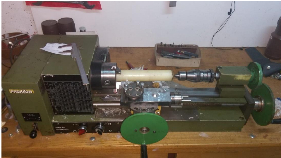
Sl.4.11. Postupak izrade kućišta zavojnice
