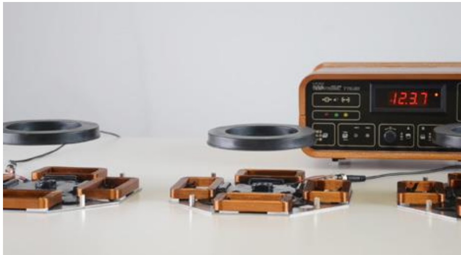
Sl.2.1. Proces elektromagnetske levitacije [3]
