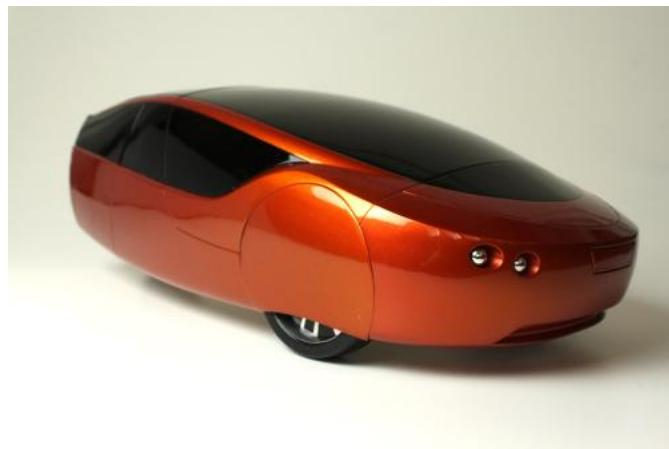
Slika 2.4. Urbee, automobil izrađen 3D printanjem. [13]
