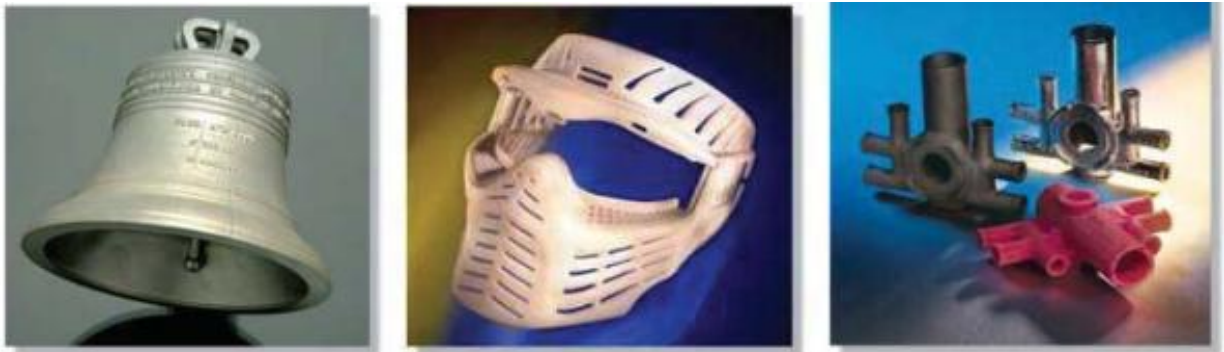
Slika 3.8. Modeli nastali primjenom SLS tehnologije [3]
