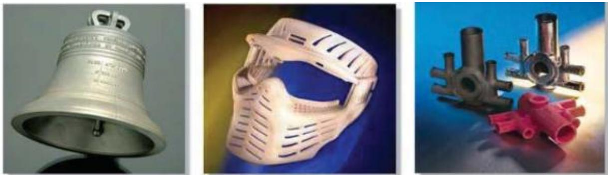
Slika 3.8. Modeli nastali primjenom SLS tehnologije [3]
