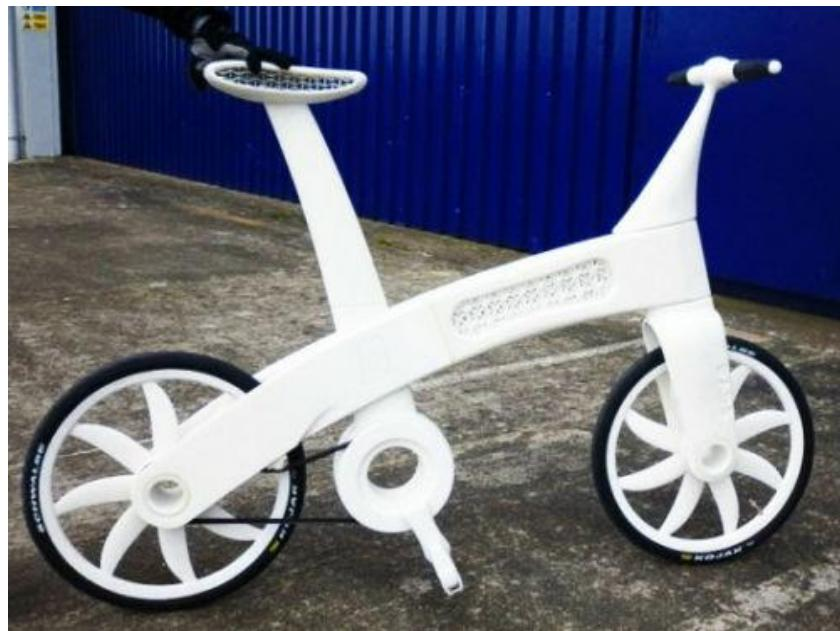
Slika 2.2. Bicikl napravljen na 3D printeru [14]
