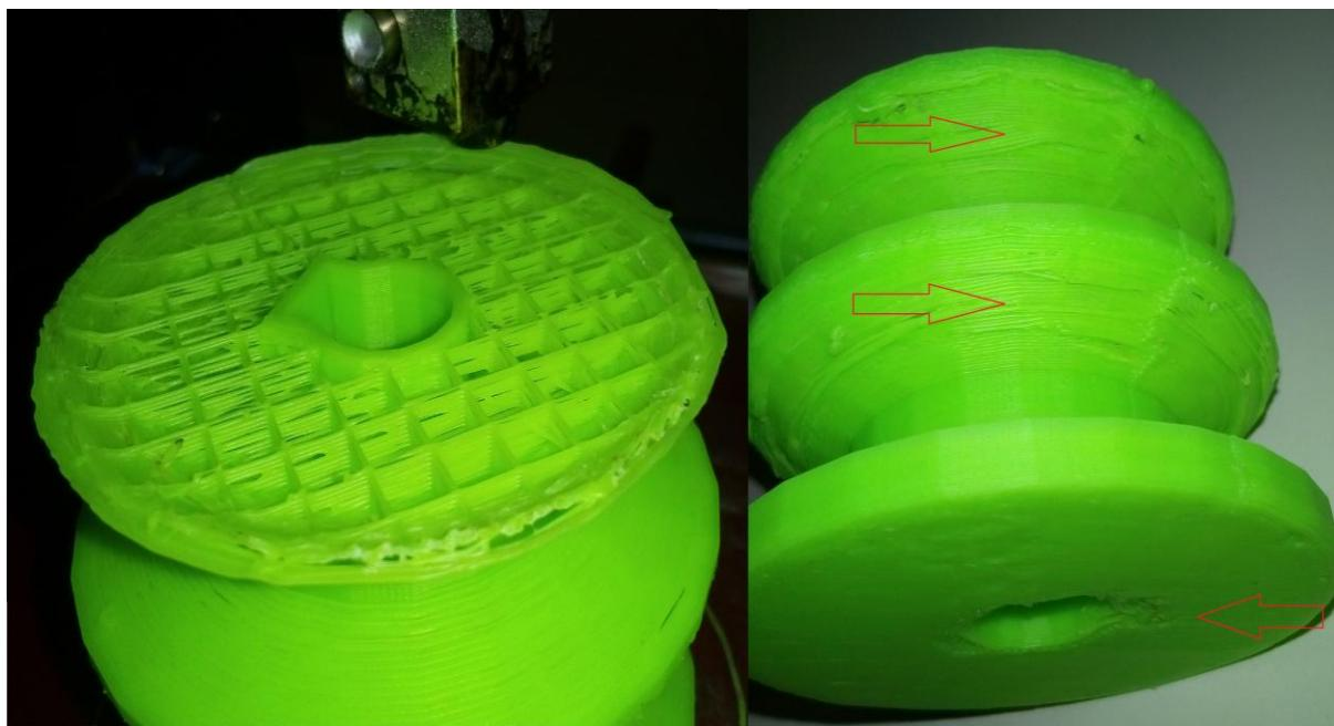
Slika 5.8. Površinske deformacije [vlastiti izvor]
