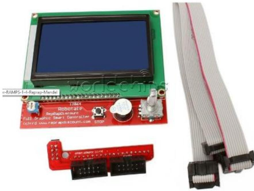
Slika 4.12. LCD sklop [2]
