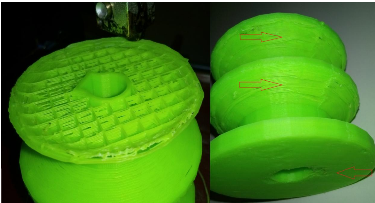
Slika 5.8. Površinske deformacije [vlastiti izvor]
