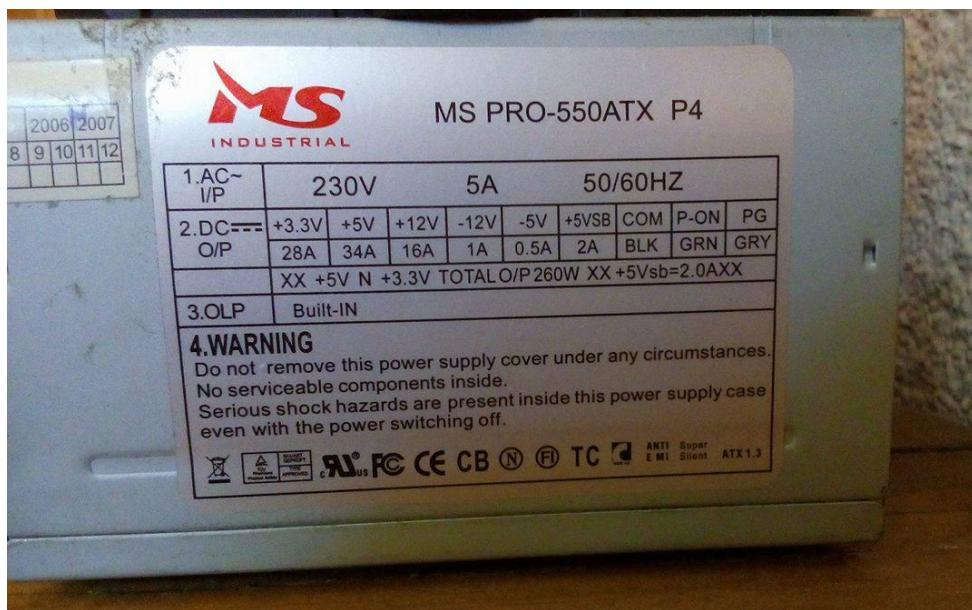
Slika 4.11. Napajanje MS PRO-550ATX P4 [vlastiti izvor]
