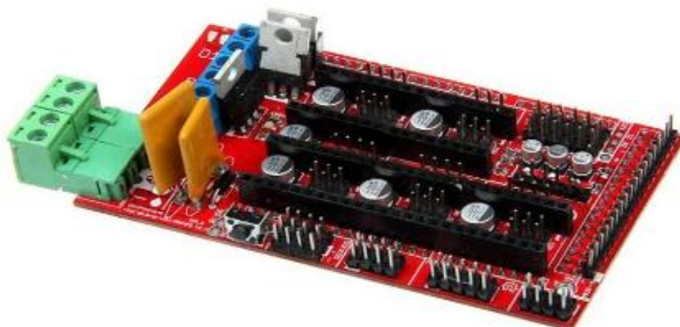
Slika 4.14. Arduino Shield RAMPS V1.4
