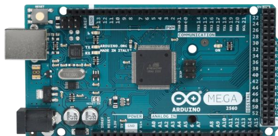
Sl. 2.3. Arduino Mega maketa s ATmega2560 mikroupravljačem
