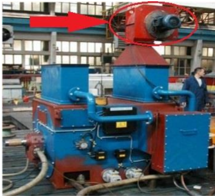
Sl. 3.7. Primjer asinkronog kaveznog elektromotora s primjenom protueksplozijske zaštite izvedene uporabom nadtlaka (Ex p).[3]
