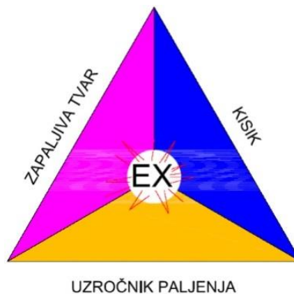
Sl. 2.1. Grafički prikaz uvjeta u protueksplozivnoj atmosferi.[1]
