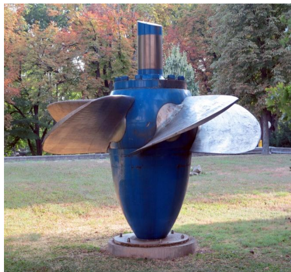
Slika 2.8. Izgled Kaplanove turbine
