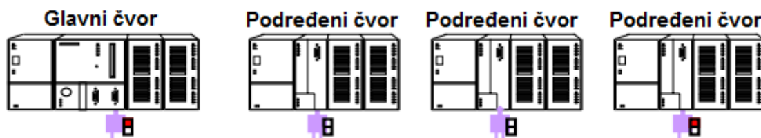
Sl. 2.4. Zaključni otpornik na PROFIBUS DP kabeu.
