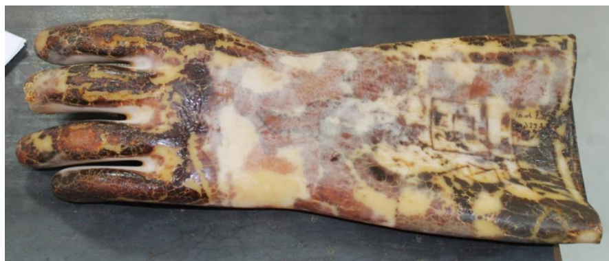
Sl. 3.9. Posljedice dugotrajnog izlaganja izolacijskih rukavica sunčevom zračenju
