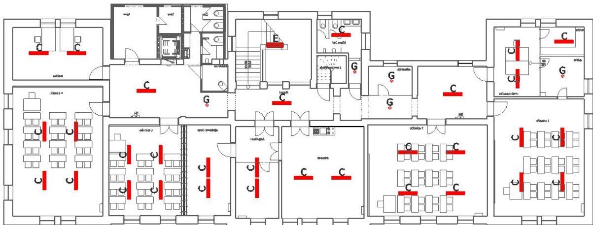
Sl. 3.4: Tlocrt prvog kata – postojeće stanje rasvjete
