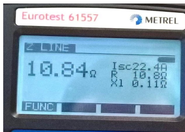
Sl. 5.8. Rezultat mjerenja impedancije petlje jednofazne utičnice 2 (pogreška uključena)
