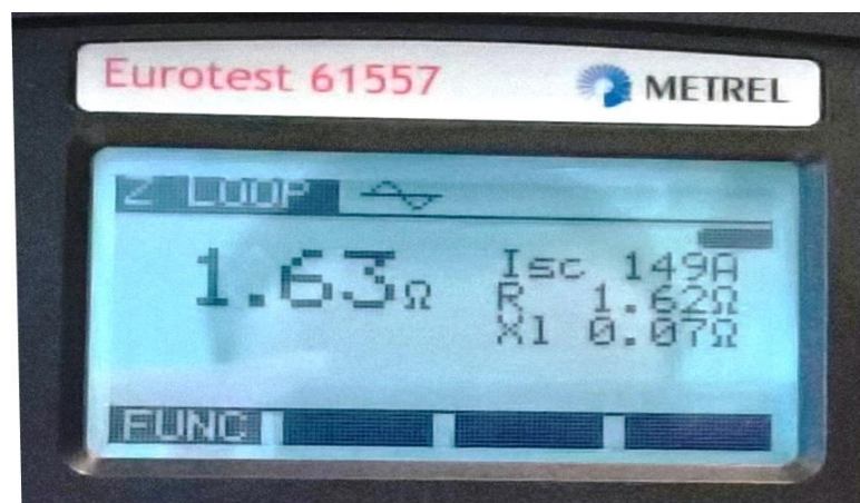
Sl. 5.9. Mjerenje otpora petlje kvara trofaznog motora
