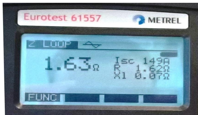
Sl. 5.9. Mjerenje otpora petlje kvara trofaznog motora
