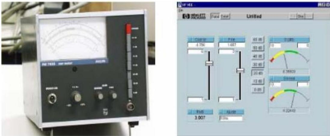
**Sl.2.2.** Prikaz klasičnog i virtualnog instrumenta[1]
