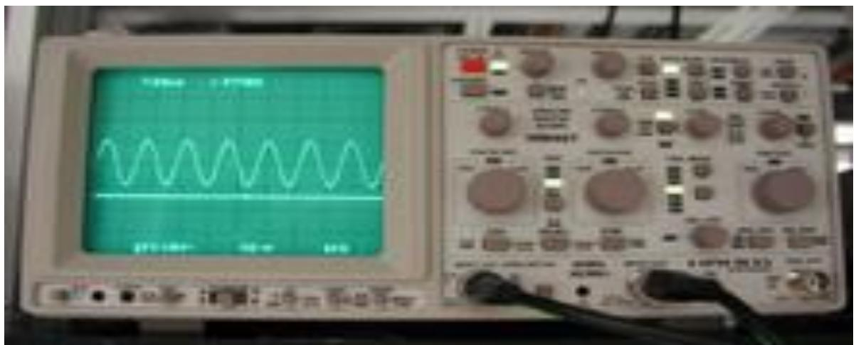
**Sl.3.1.** Prikaz sinusnog napona na zaslonu osciloskopa[9]
