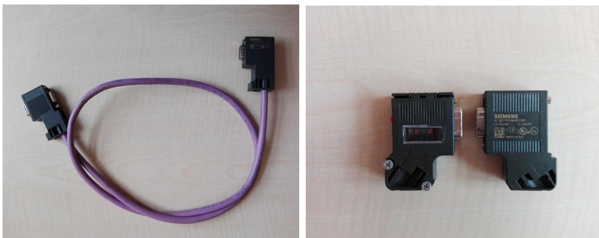
Slika 3.7. Oklopljeni dvožični vod (lijevo) i D-sub konektor (desno)
