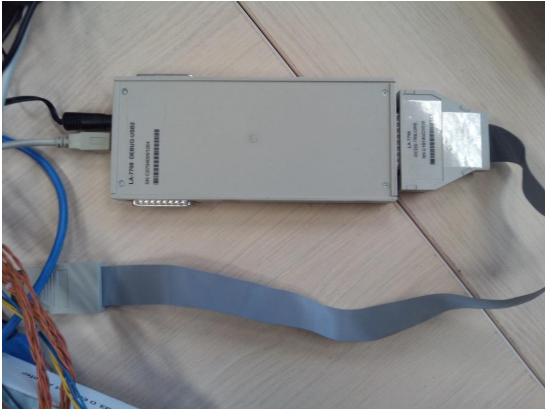
Sl. 3.5. Lauterbach uređaj za analizu pogrešaka
