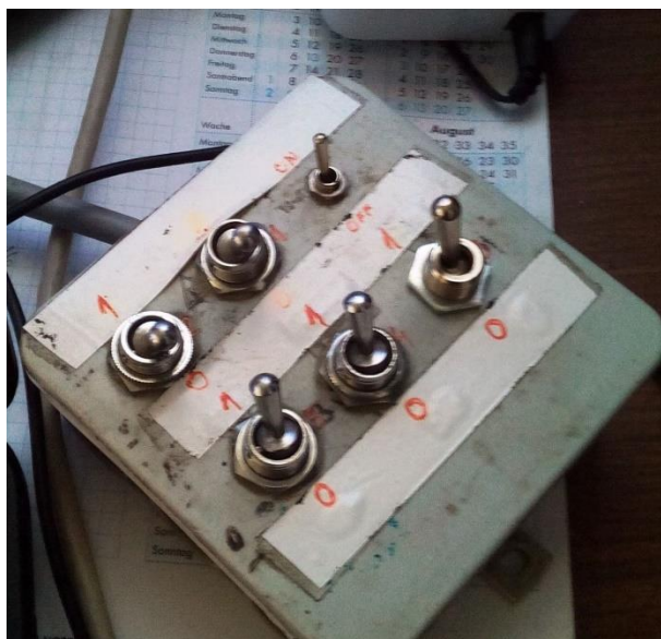
Slika 6.4. Improvizirani kip prekidači
