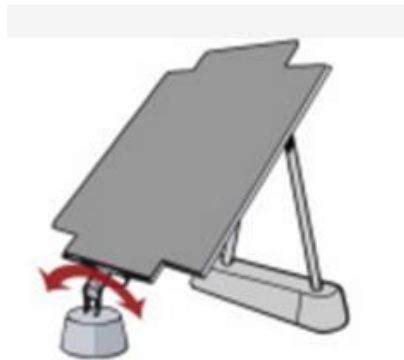
Slika 3.5. Izgled jednoosnog vertikalnog sustava za praćenje [12]
