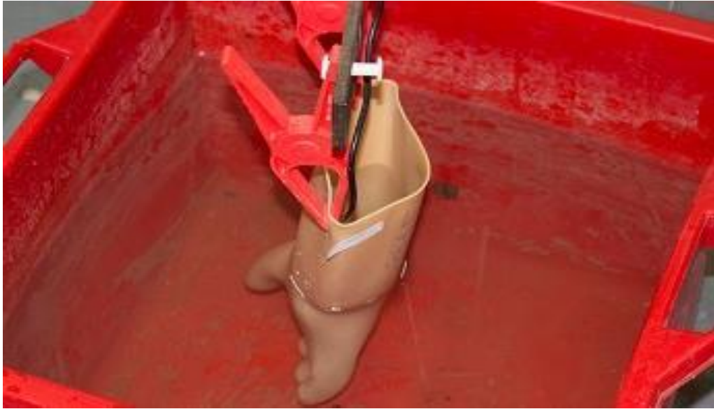
Slika 4.7. Laboratorijsko ispitivanje izolacijske rukavice [5]
