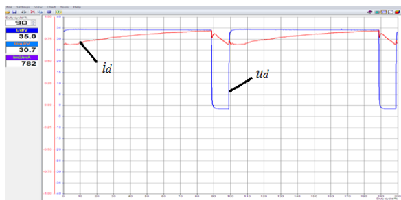
Slika 4.20. Valni oblici struje i napona trošila za faktor vođenja: a) \alpha=30\% , b) \alpha=60\% , c) \alpha=90\%
