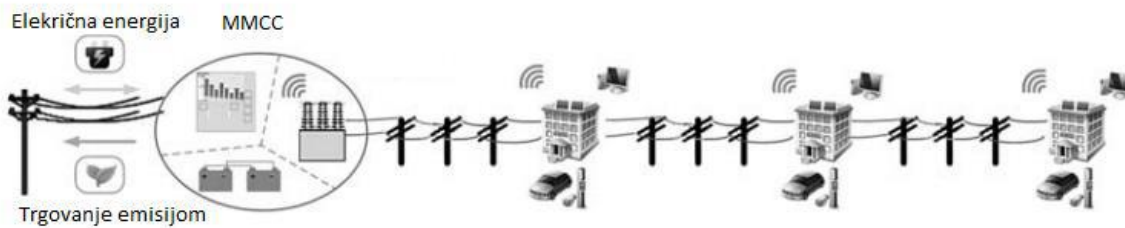
Slika 2.6. Mikromreža na razini niskonaponske mreže [8]
