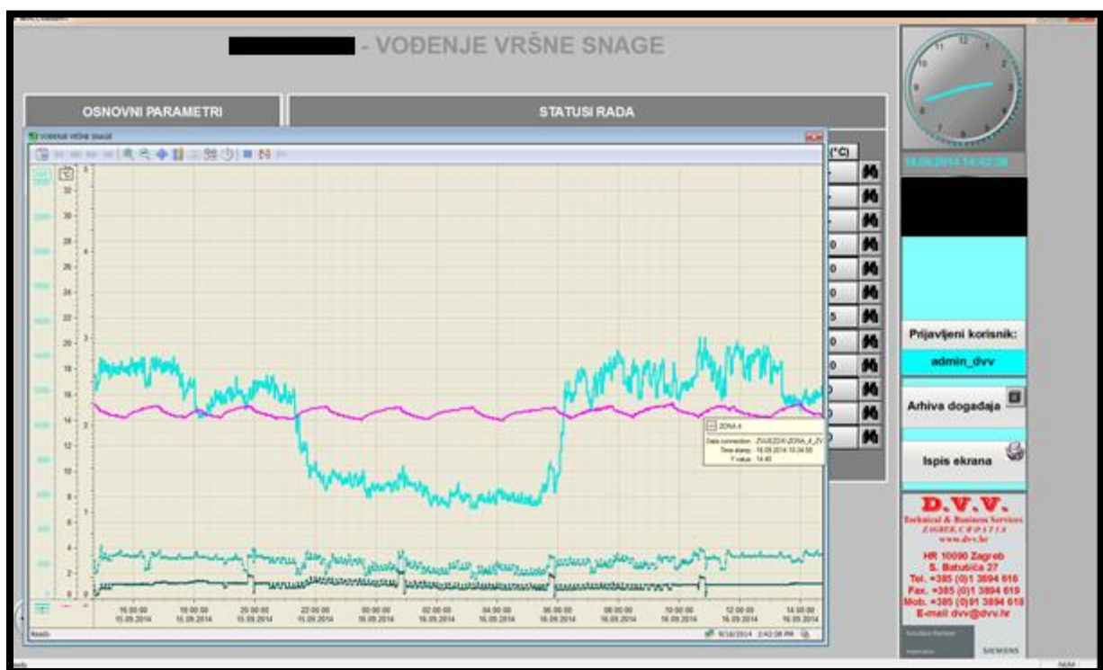
Slika 3.22. Vremenski dijagram potrošača unutar funkcije vođenja vršne snage
