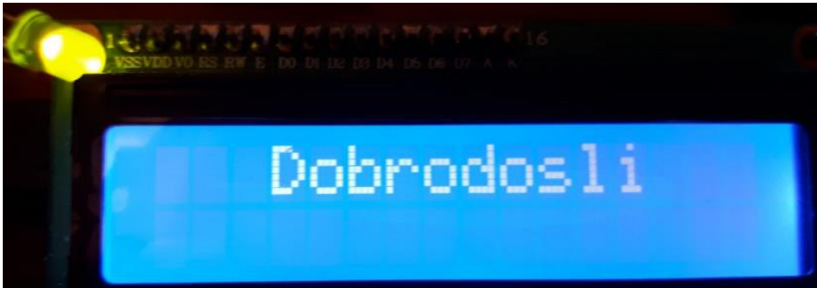
Sl. 5.3. Poruka nakon točnog unosa PIN-a
