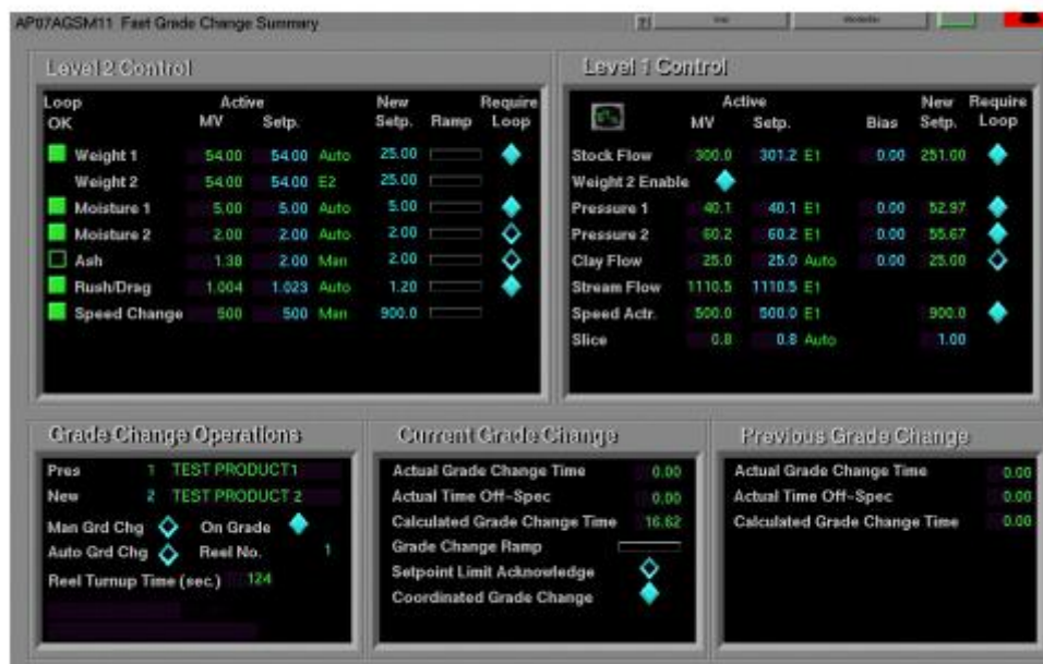
Slika 5.10. Prikaz automatske promjene razreda proizvodnje [16].
