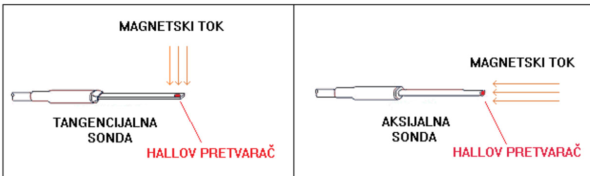
Sl. 2.4. Tangencijalna i aksijalna sonda [2]
