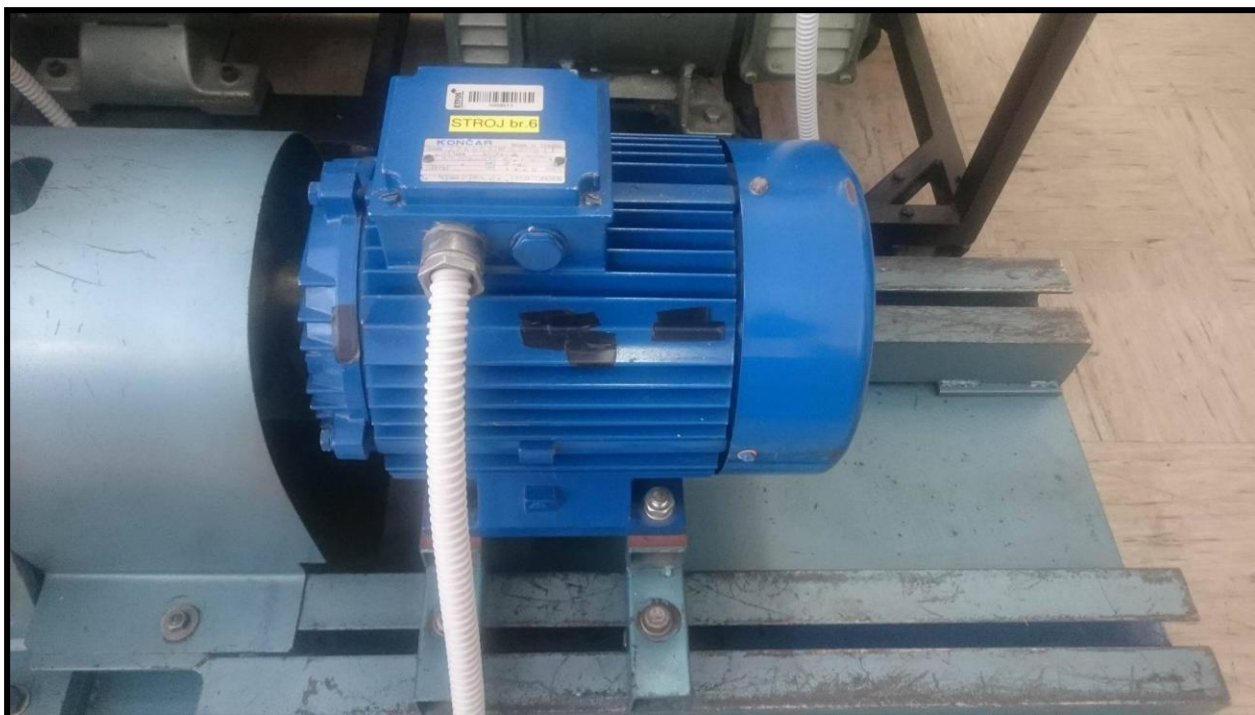
Slika 2.2. Laboratorijski asinkroni kavezni motor
