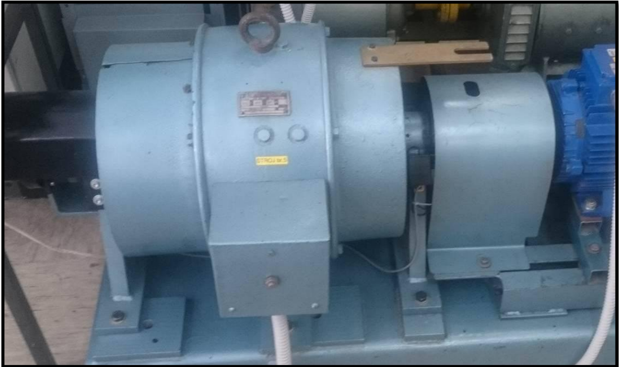
Slika 4.1. Istosmjerni generator marke Siemens – Schuckert
