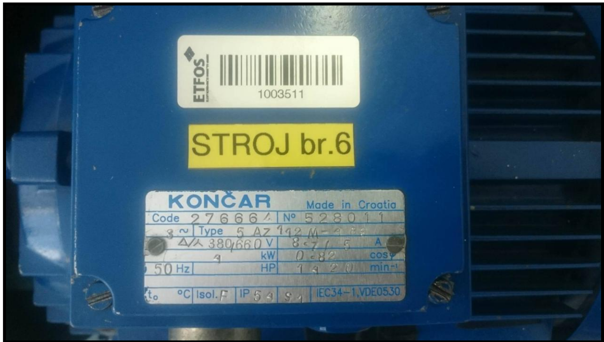
Slika 4.2. Laboratorijski asinkroni motor marke Končar
