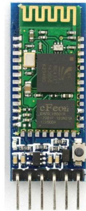
Slika 3.2.1.8. HC-05 Bluetooth module
