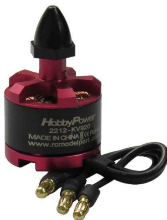
Slika 3.2.1.3 Motor korišten u maketi [11]
