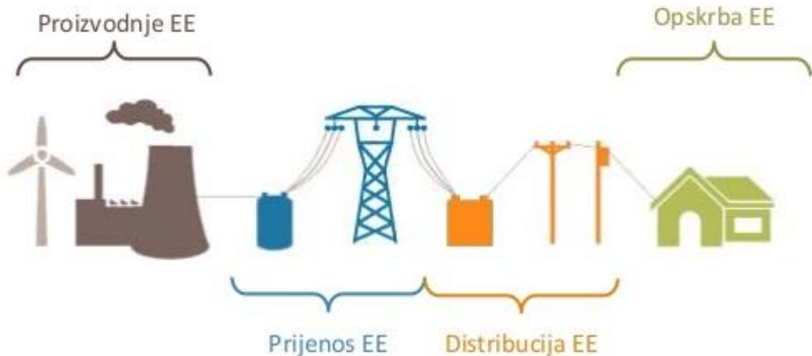
Sl. 2.1. Načelna shema elektroenergetskog sustava [2]
