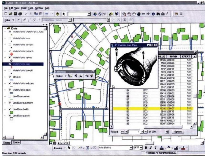
Slika 3.6. Primjena Arc Map-a za upravljanje vodovodnom infrastrukturom
