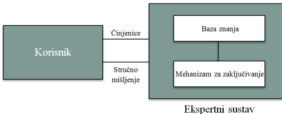
Slika 4.2. Osnovni koncept ekspertnog sustava [9]
