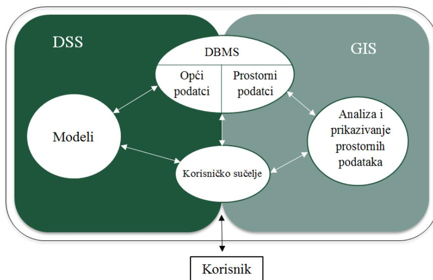
Slika 5.4. Tradicionalne komponente ekspertnog sustava (DSS) i GIS-a [1]
