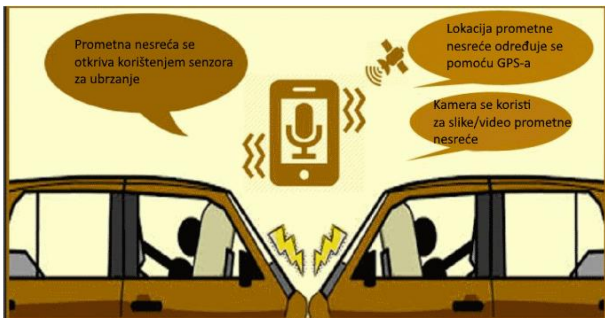
Slika 3.3. Detekcija prometne nesreće pomoću mobilnog uređaja
