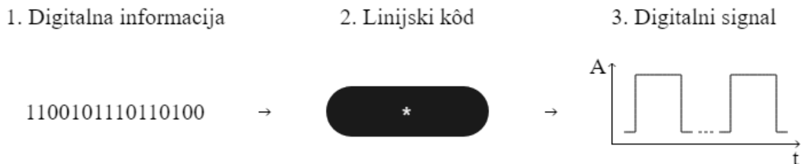
Slika 2.1. Uloga linijskog koda u komunikacijskom kanalu
