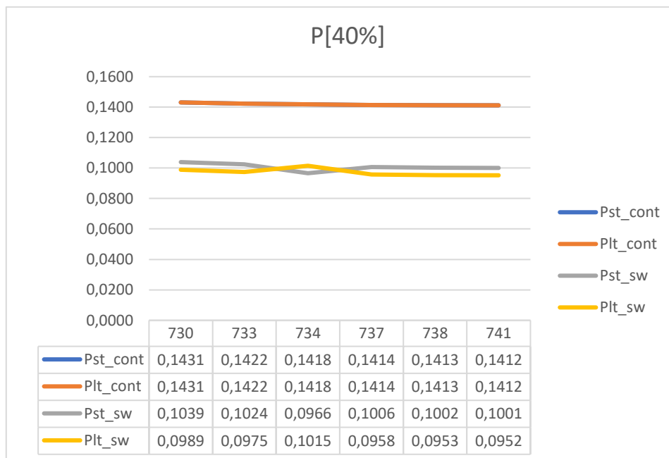
Graf 5.5. Prikaz promjene faktora treperenja na karakterističnim sabirnicama za izlaznu snagu agregata iznosa 40% ukupnog opterećenja
