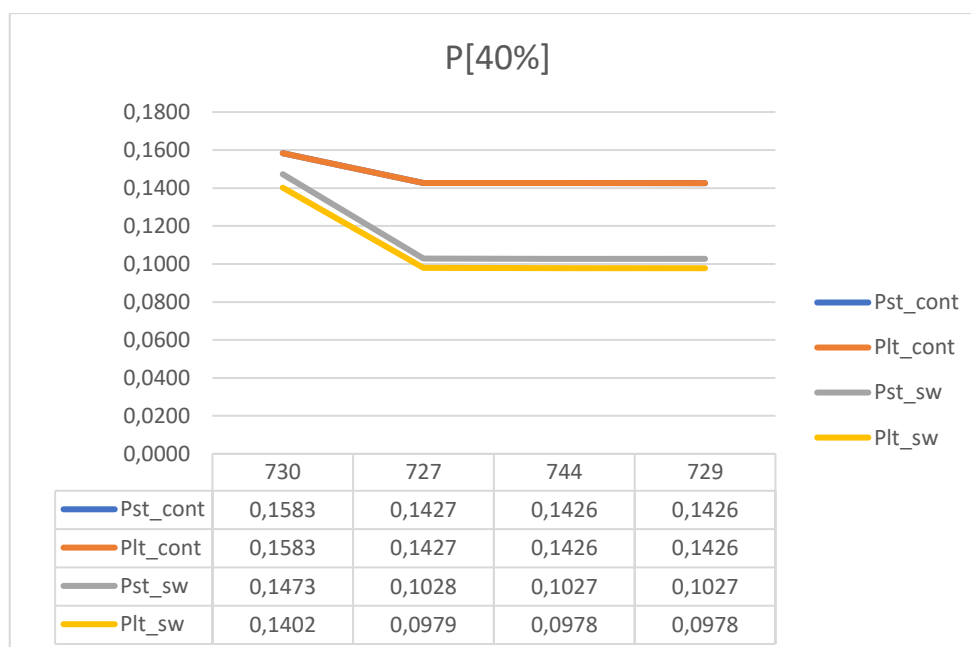
Graf 5.41. Prikaz promjene faktora treperenja na karakterističnim sabirnicama za izlaznu snagu agregata iznosa 40% ukupnog opterećenja
