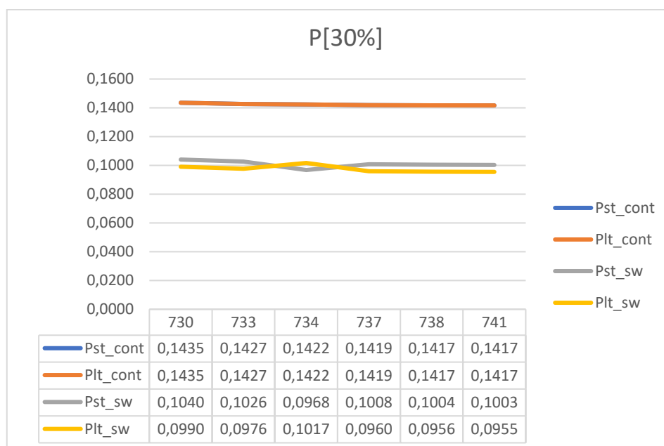
Graf 5.1. Prikaz promjene faktora treperenja na karakterističnim sabirnicama za izlaznu snagu agregata iznosa 30% ukupnog opterećenja
