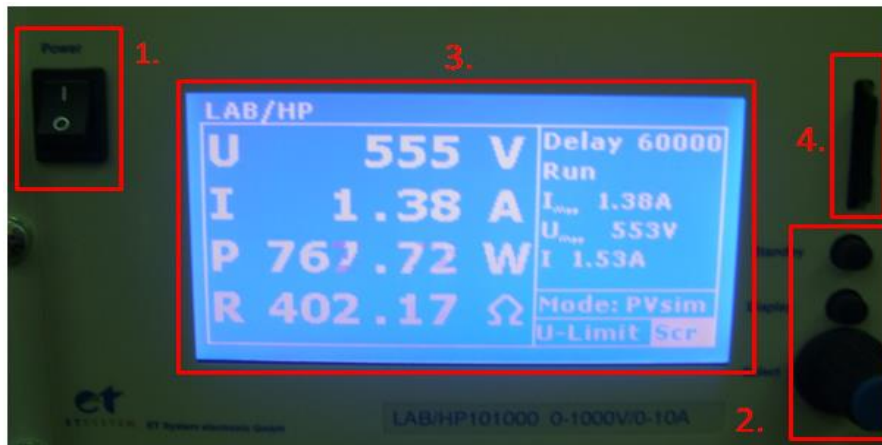
Slika 2.7. Prikaz prednje upravljačke ploče istosmjernog izvora
