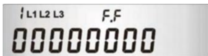
Slika 2.6. Pokaznik za utvrđivanje ispravnosti spoja brojila
