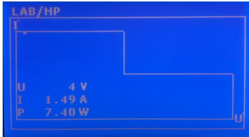
Slika 2.17. Grafički prikaz izlazne u-i karakteristike
