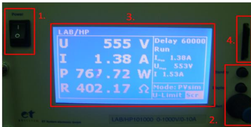
Slika 2.7. Prikaz prednje upravljačke ploče istosmjernog izvora
