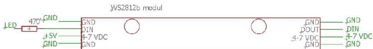
SI 3.9. Shema spajanja LED modula
