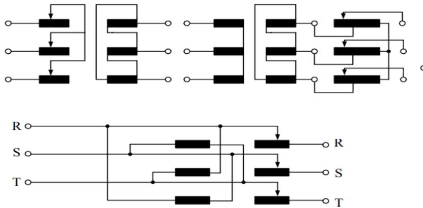
Slika 2.7.3.2. Regulacija napona na transformatoru [14]
