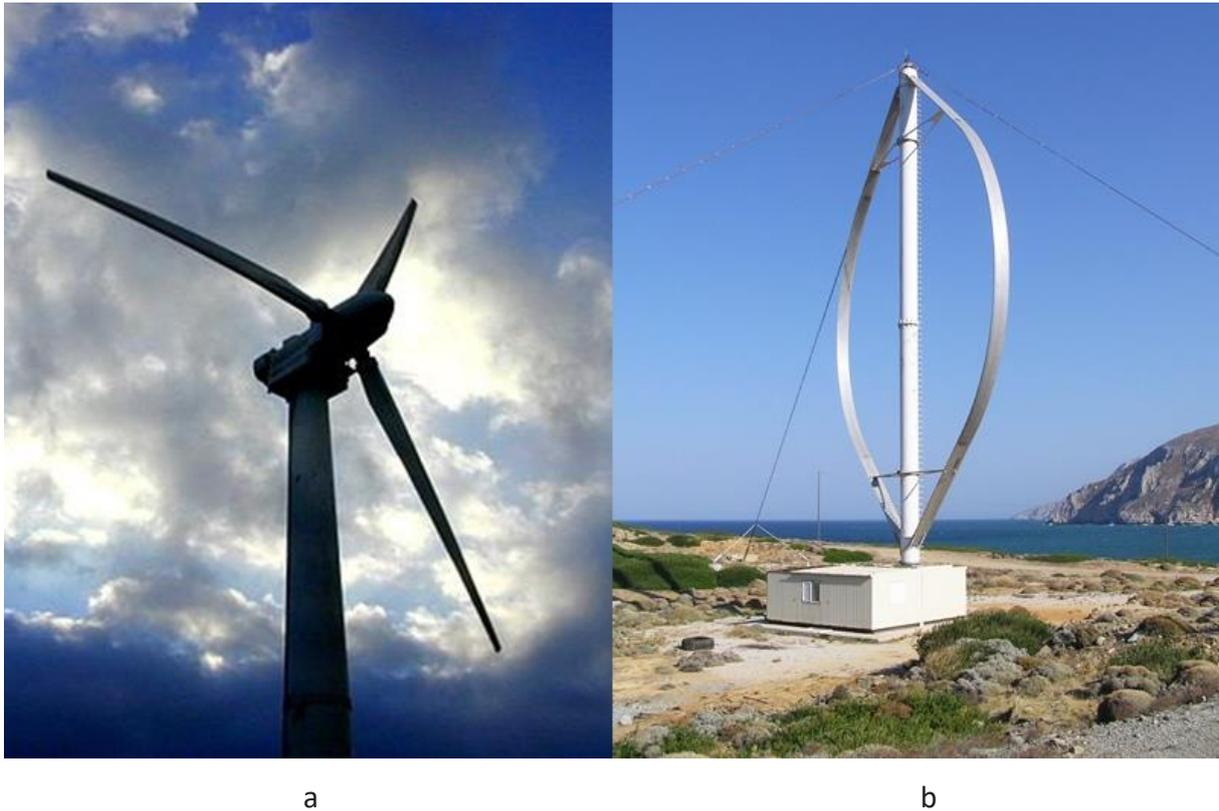
Slika 2.3.1. a) agregat s vodoravnim rotorom b) agregat s okomitim rotorom
