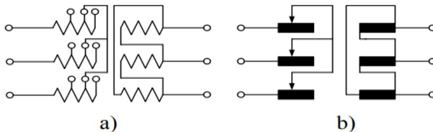
Slika 2.7.3.1. a) transformator s odvojcima, b) regulacijski transformator
