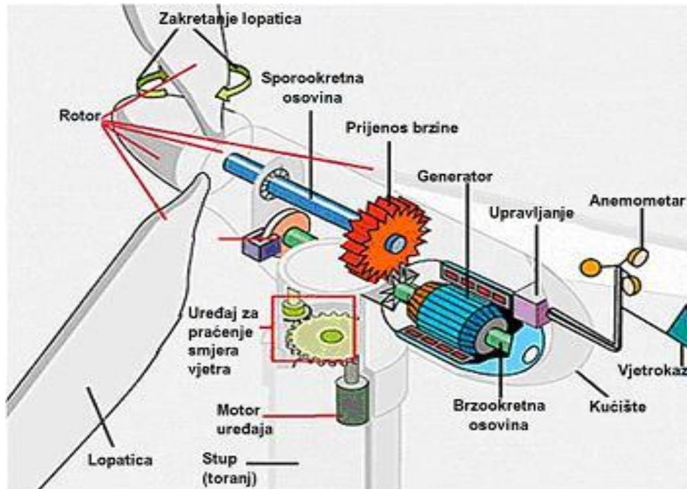
Slika 2.2.1 Dijelovi vjetroagregata [8]
