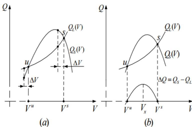
Slika 2.6.1.3.  $Q_S(V)$  i  $Q_L(V)$  karakteristike: a) dvije ravnotežne točke, b) ilustracija kriterija stabilnosti
