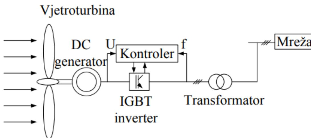
Slika 2.12.1. Istosmjerni sustav [19]
