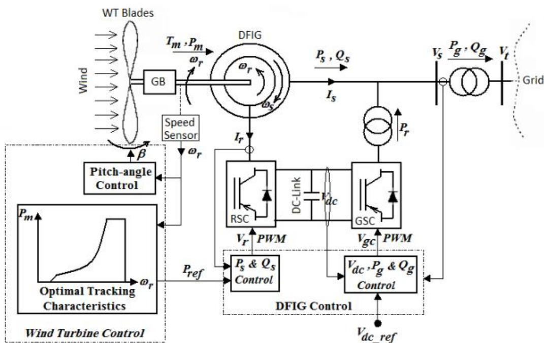
Slika 2.14.5. Blok shema DFIG-a baziranog na VSWT [1]
