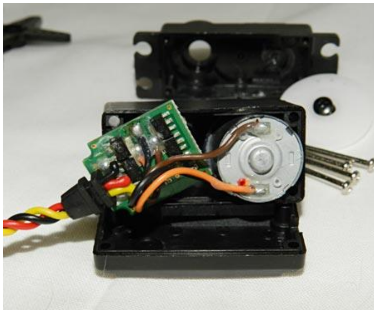
Slika 2.6 Tiskana pločica servo motora, [2]
