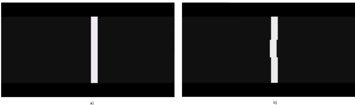
Sl. 2.10. Usporedba (a) izvornog okvira (b) okvira s artefaktom kidanja slike [16].
