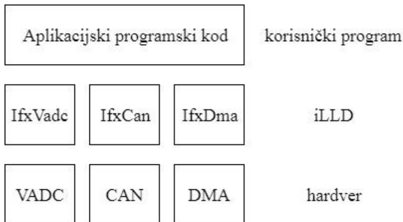
Slika 3.3. Prikaz jednofunkcionalnih upravljačkih programa [5]
