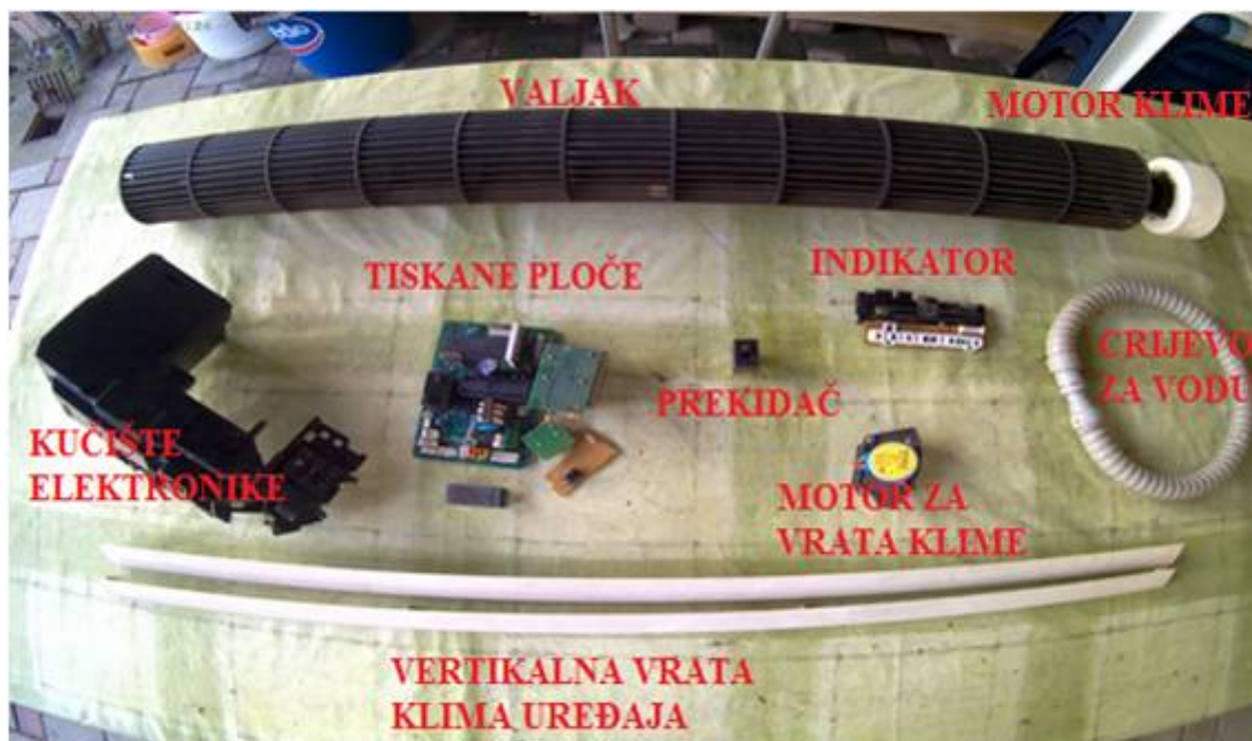
Slika 4.6. Prikaz pojedinih rastavljenih dijelova klima uređaja
