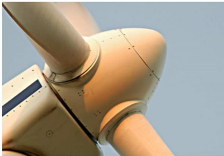
Slika 3.1: Stacionarni mirujuć i rotirajući dio oplata vjetroagregata [2]
