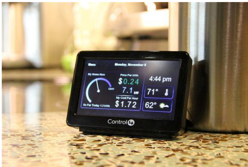
Slika 2.7. Izgled kontrolne jedinice za pregled potrošnje
