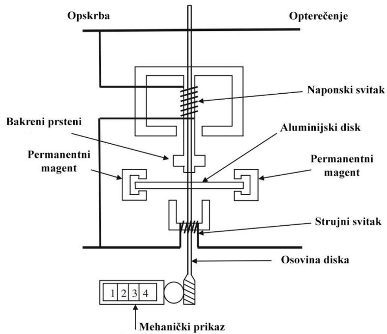
Slika 3.2. Prikaz komponenti jednofaznog elektromehaničkog brojila
