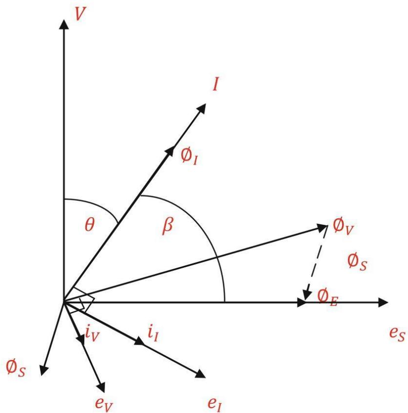
Slika 3.3. Fazorski dijagram jednofaznog elektromehaničkog brojila
