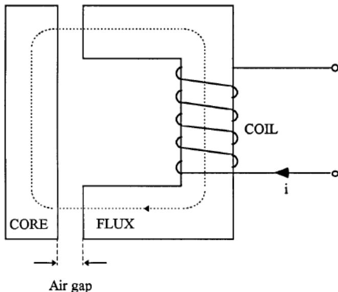
Sl. 6.3. Princip rada induktivnog senzora
