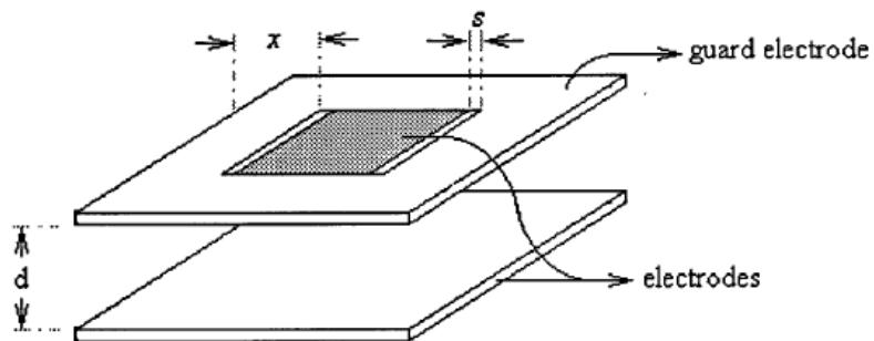
Sl. 3.8. Prikaz kapacitivnog senzora u tipičnom položaju
