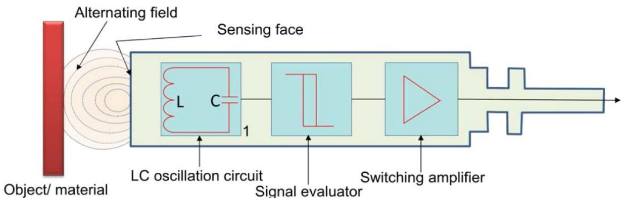
Sl. 6.5 Induktivna blizinska sklopka
