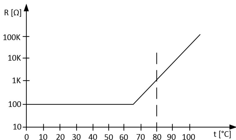
Sl. 3.5. Promjena u otporu kod pozitivnog termistora
