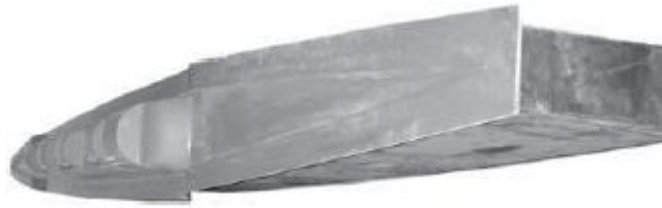
Sl. 3.13. Kalup za unutarnju strukturu [6]
