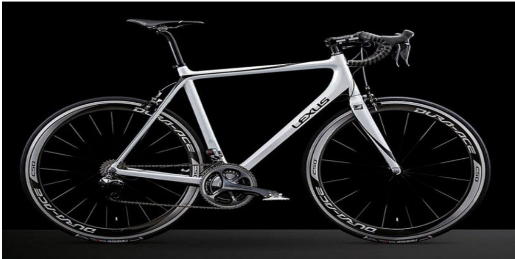
Sl. 3.22. Natjecateljski bicikl sa okvirom od ugljični vlakana [18]
