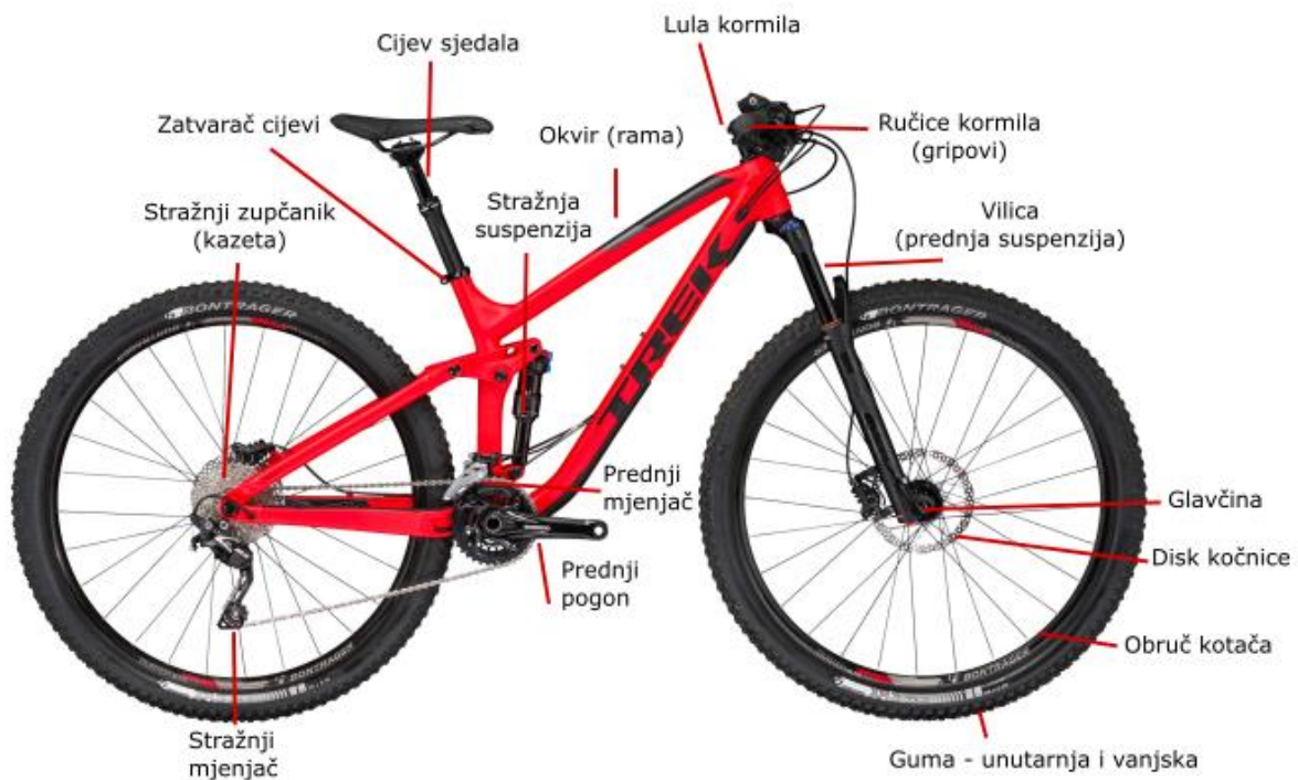
Sl. 3.19. Sastavni dijelovi modernog bicikla [14]
