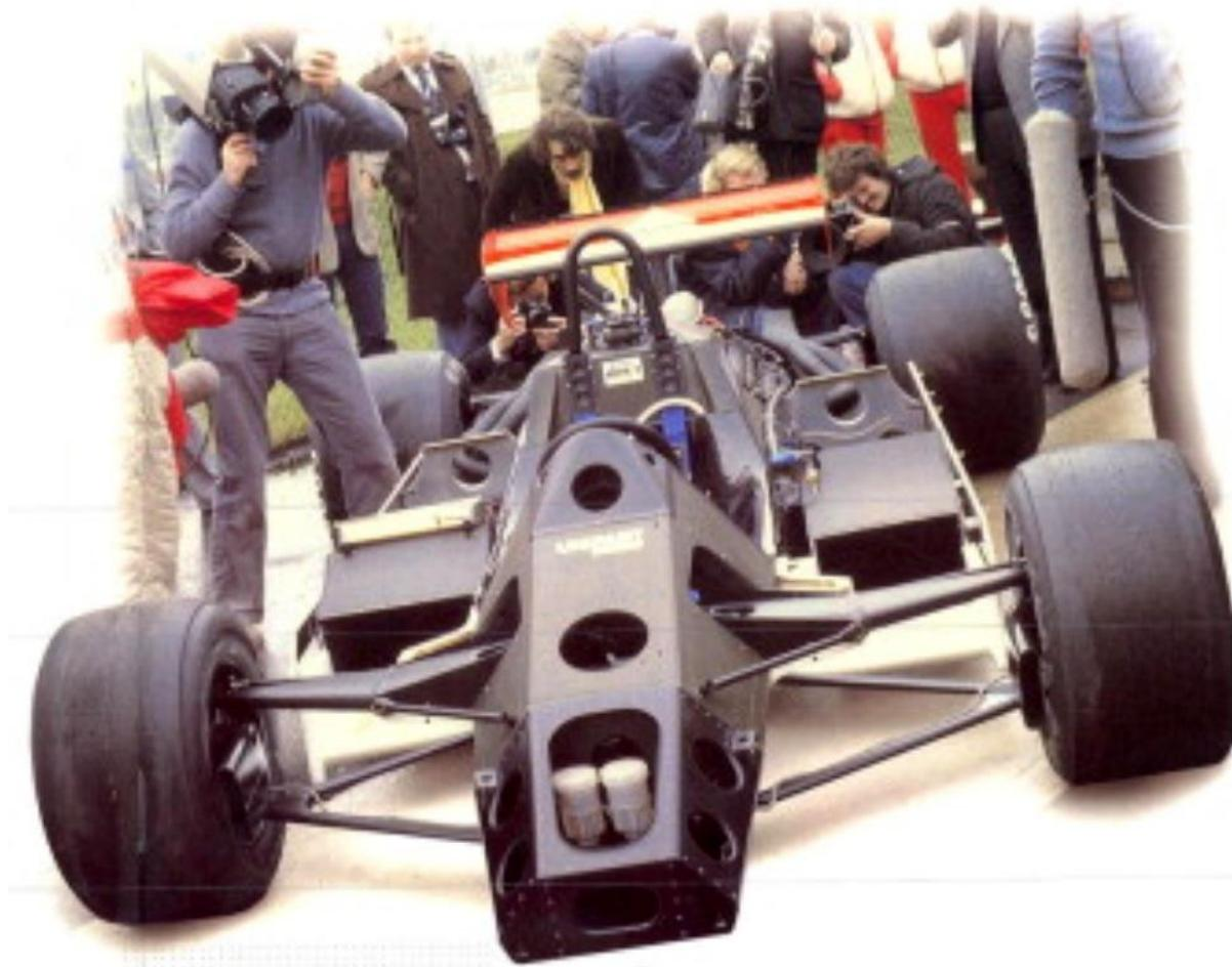
**Sl. 3.5.** Prvi bolid izgrađen od ugljičnih vlakana [8]
