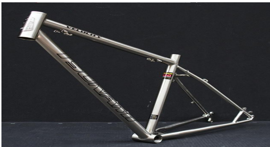
Sl. 3.21. Okvir izrađen od Reynolds 531 poboljšanog čelika [17]
