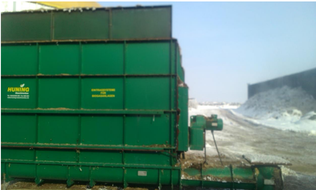
Slika 5.7. Prikaz dozirnog kontenjera
