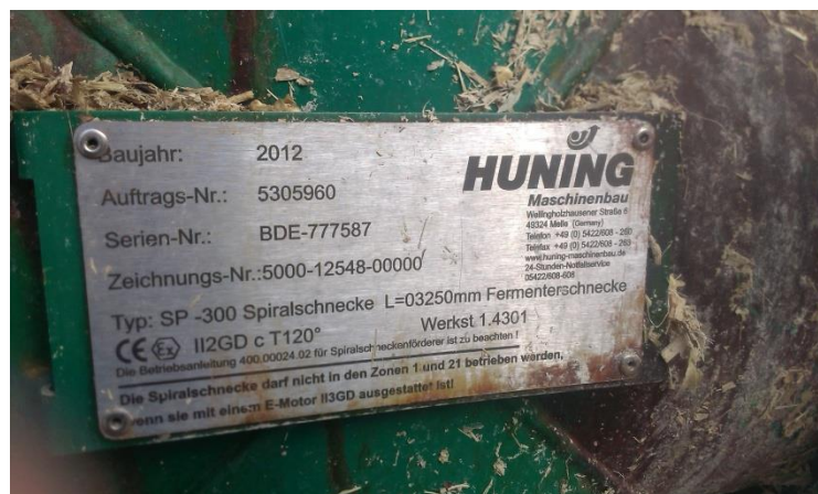
Slika 5.8. Natpisna pločica dozirnog kontenjera
