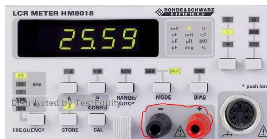
Slika 4. Priklučnice za stezaljke
