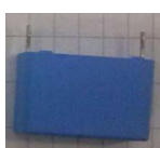
Slika 3.3 Blok kondenzator nazivnog kapaciteta 2.2μF
