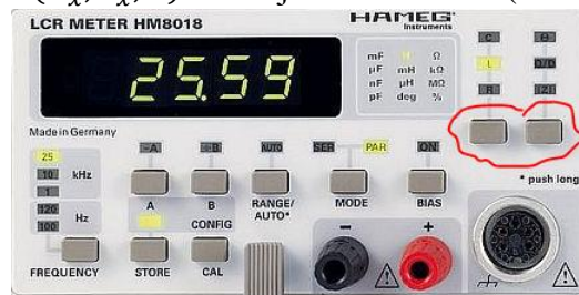
Slika 5. Tipke za izbor mjerene komponente
