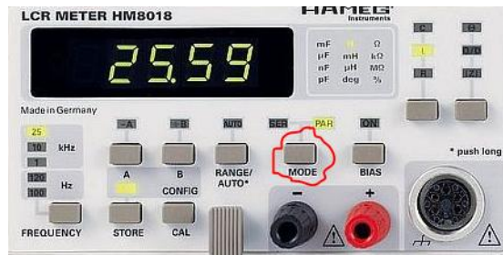
Slika 8. Tipka za izbor paralelnog/serijskog načina
