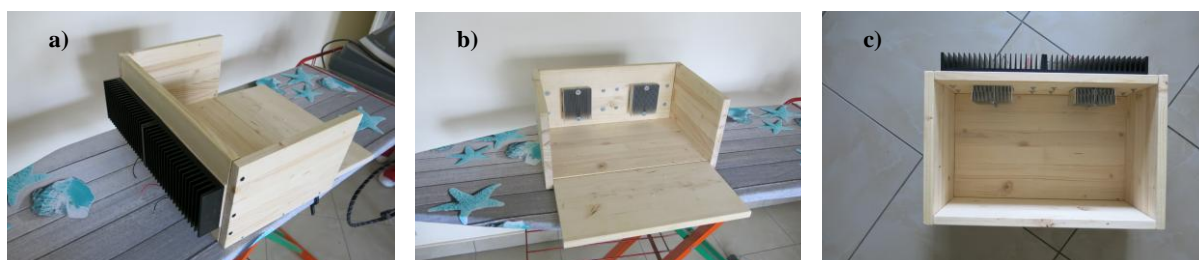
Slika 8.1. Pogled na vanjske i unutarnje rebraste hladnjake u početnoj fazi izrade termoelektričnog hladnjaka, a) vanjski rebrasti hladnjaci, b) unutarnji rebrasti hladnjaci i c) pogled odozgo na vanjske i unutarnje rebraste hladnjake
