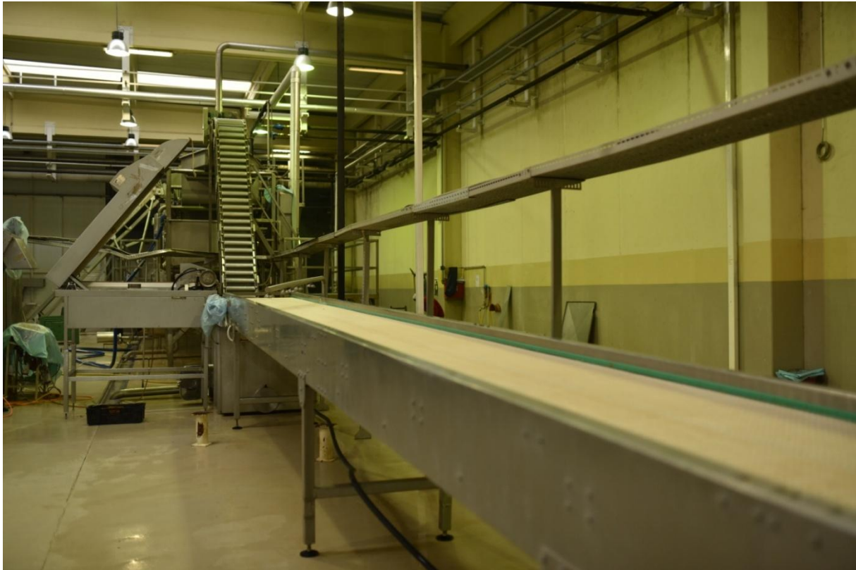
Slika 3.16. Vibrirajući transporter – dozator [1]
