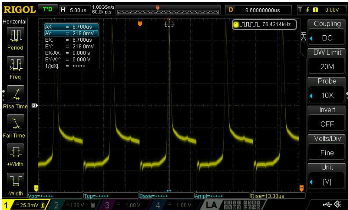
3.1.9 Izgled signala (pravokutnog) na izlazu iz derivatora mjernog kapaciteta 150pF ( f=76,42 kHz)
